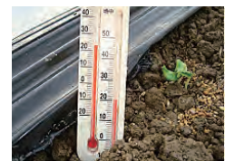
地温計による地温測定
