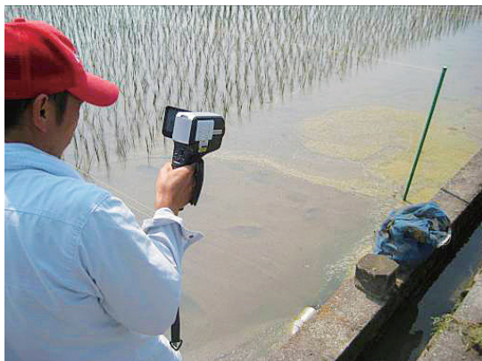
（サーモグラフィーによる表面温度分布測定）
